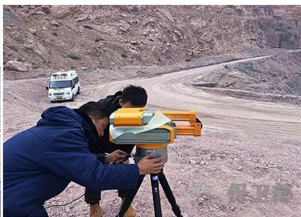
在实操训练中，每名参训队员依次对设备架设、设备连接、寻星定位、音视频测试等内容进行了操作，达到了训练的预期目的。
